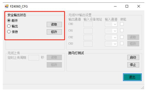
安全输出状态:继电器输出模块的上的起始状态,该功能重启有效。
