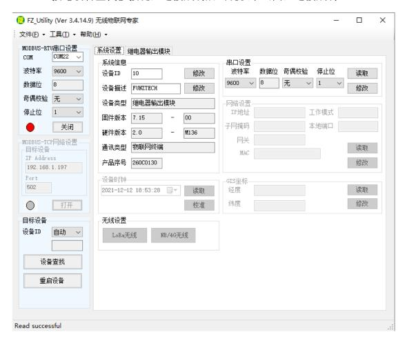
注意: 遗忘模块的串口设置,长按 CFG 按键,待蜂鸣器嘀 3 声后松开按键,系统的串口配置变为: 9600-8-N-1;该操作并不改变实际的串口配置,重启或者 30 秒无串口通讯,系统恢复正常的串口配置。
